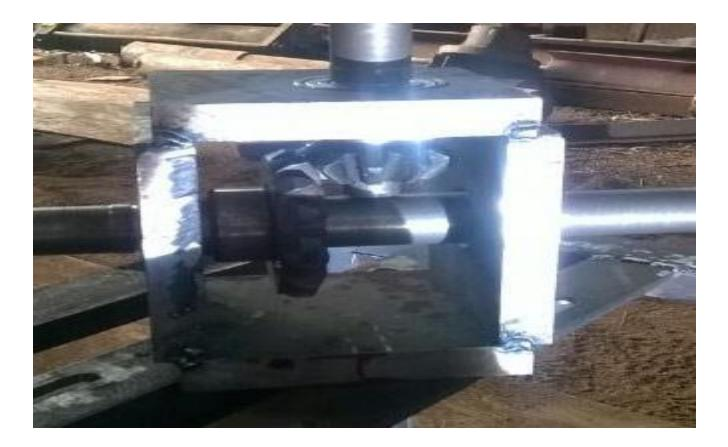
Pinion teeth:-16 Gear teeth:-10 Gear ratio:-1.6
